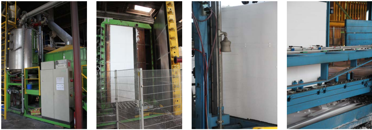
Bild 10: Herstellung einer Hartschaumplatte (Fa. isoBouw, Werk Abstatt) von links nach rechts: Vorschäumen, Blockschaumherstellung, Konfektionierung und Rückführung des Zuschnitts.
