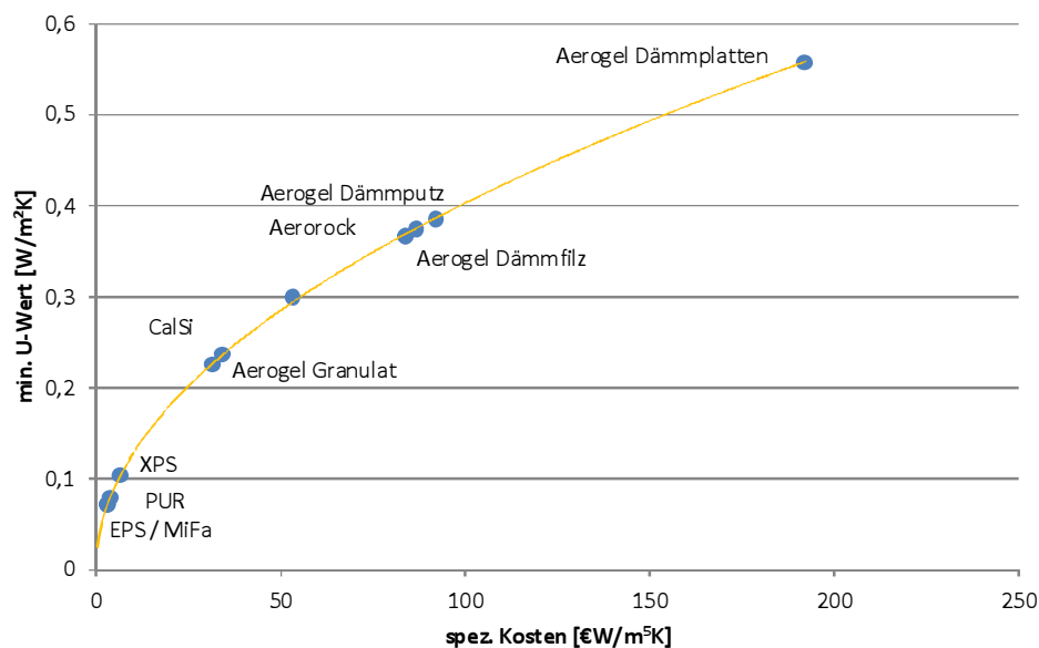
Abbildung 4.17: Ableitung der kostenoptimalen U-Werte aus den spezifischen Kosten
