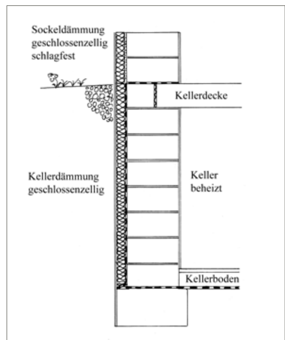
Bei beheizten Kellern wird die Außenwand gedämmt. Das geschlossenzellige Dämmmaterial ist zugleich Schutz gegen Feuchtigkeit aus dem Erdreich.
