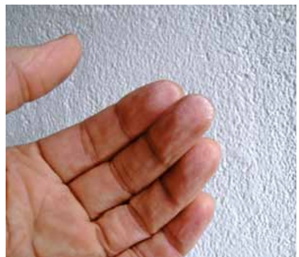
Kalkfarbe ist weniger abriebfest als handelsübliche Dispersionsfarbe. Ein Schuss Leinölfirnis verbessert die Festigkeit.
