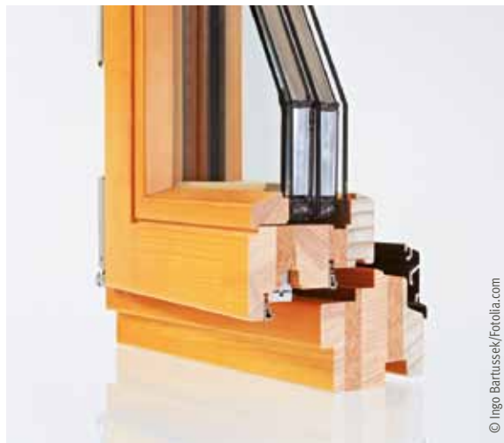
Schnitt durch ein Passivhausfenster mit Holzrahmen (Sigg-Fenster): Dreifachverglasung, wärmegedämmte Rahmenprofile, zwei bis drei Dichtungsebenen und die Ausbildung des Scheibenrandverbundes als „warme Kante“ zeichnen ein Holzfenster von hoher Qualität aus.
